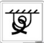
La máquina debe anclarse al remolque de transporte en todos los puntos de anclaje previstos. Los puntos de amarre de la máquina están marcados.
