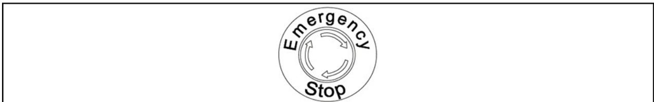
En caso de situación peligrosa, pone inmediatamente la máquina en estado seguro. Tras accionar la parada de emergencia, hay que desbloquear de nuevo el interruptor y confirmar el estado seguro de la máquina pulsando un botón.
